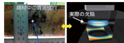
図2：鋼材中の貫通横穴の可視化結果
