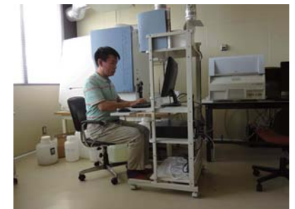
図3. 誘導結合プラズマ発光分光分析装置
