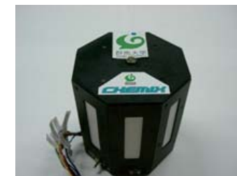
図3 開発した高濃度メタノールを利用するパッシブDMFC
