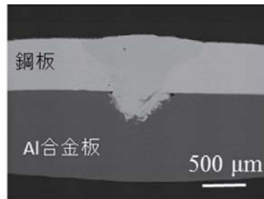
図1 鋼板とAl合金板のレーザースポット接合
