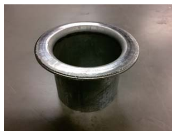
図1 冷間フレア成形したSGP管
