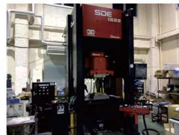
図3 サーボプレス機 (最大150トン)
