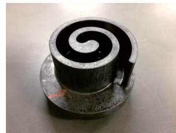
図2 マグネシウム合金の鍛造スクロール
