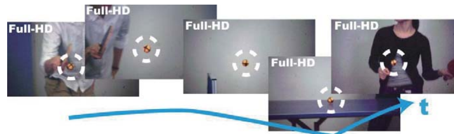
図3. 1msオートパンチルトによる卓球のトラッキング結果
