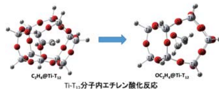
図2 (HTiO 1.5 ) 12 (Ti-T 12 )のかご内に包摂されたエチレンが酸化されてエポキシドになる反応
