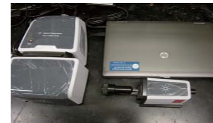
小型赤外分光光度計と制御用ラップトップ
