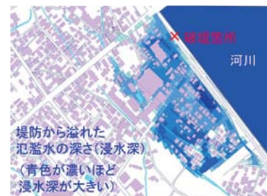
堤防から氾濫した水流の数値シミュレーションによる浸水深予測
