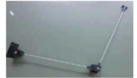
写真2 試作中のフレキシブルリンクロボットアーム
