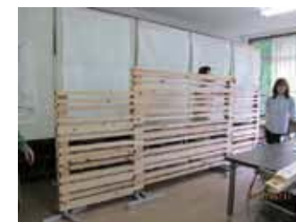
従来の木材としては利用用途の少ない寸法の材料を利用した木製パーティションの試作品「もくべえ」
