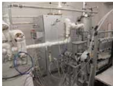
実証中の水蒸気-水添ハイブリッドガス化プロセス
