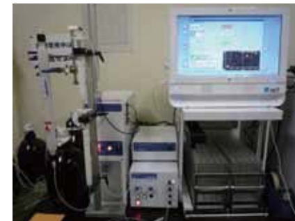
化合物の単離・精製に用いる中圧自動カラムクロマトグラフ装置
