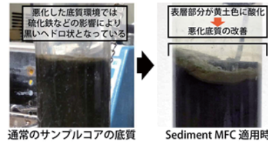
通常のサンプリングコアの底質 Sediment MFC 適用時 底質浄化への応用例と底質改善効果
