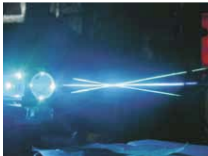
レーザドップラ流速計の光
