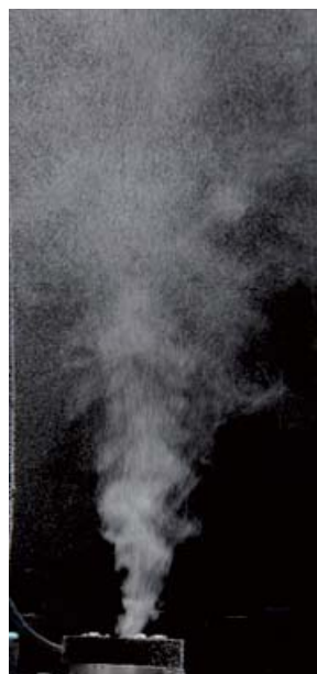
図1. 微細気泡発生装置MiBosを用いた水中への空気の微細気泡化
