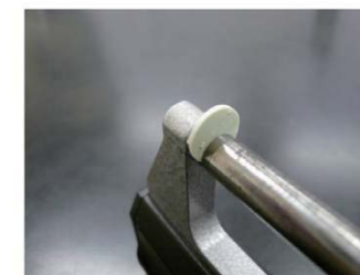
リチウムイオンが動くセラミックス固体電解質の円板(斜め方向より撮影)
