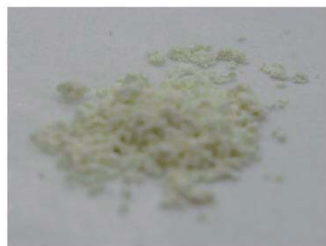
リチウムイオンが動くセラミックス固体電解質粉末
