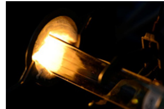
図2 高温で熱処理し、有機物からカーボン材料を作っている様子
