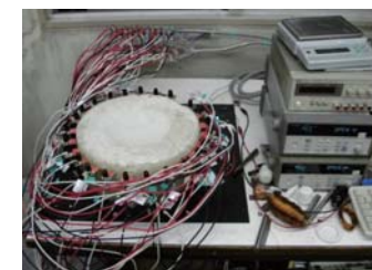
計測システムの外観と人体の腹部を模したファントムでの実験
