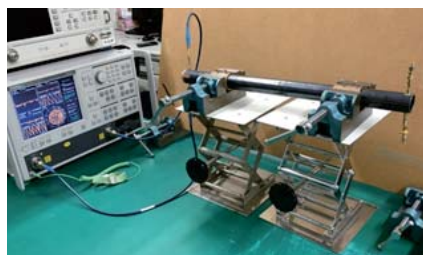
被測定対象の金属管と計測器 (ベクトルネットワークアナライザ)
