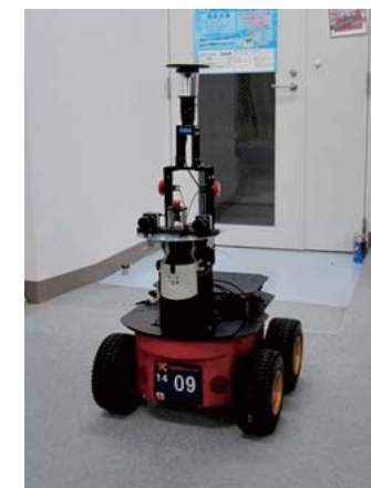
リバストと共同開発したロボット。視覚によるナビゲーションもできるようカメラを装備している。
