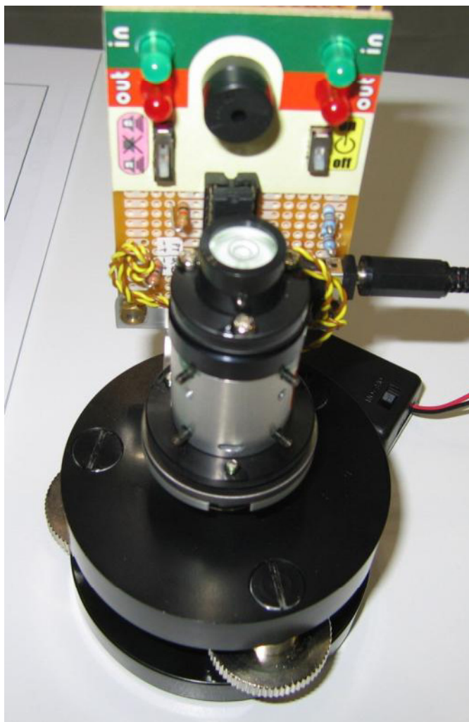
株式会社マイゾックス 提供 試作品 中央円柱部がセンサ
