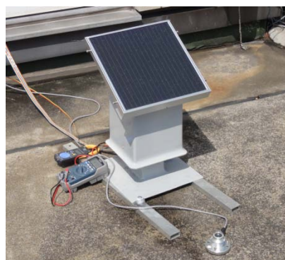
日射量と稼働測定
