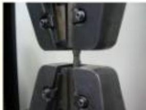
プレス製品から切り出した試験片で材料試験
