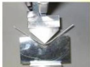
Mg板材の冷間曲げ加工
