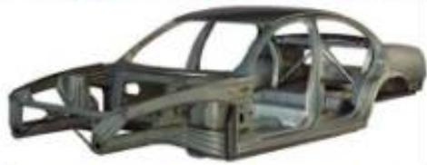
鋼板の高張力化(590-1180MPa級ハイテン)
