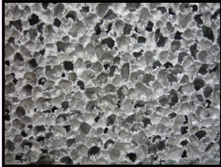
クローズドセル型(独立気孔)
