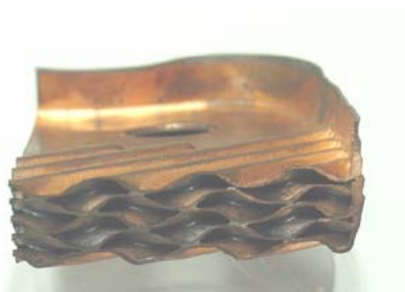
複合Cu-Pめっき層を用いた プレート熱交換器の試作例 (接合部断面)
