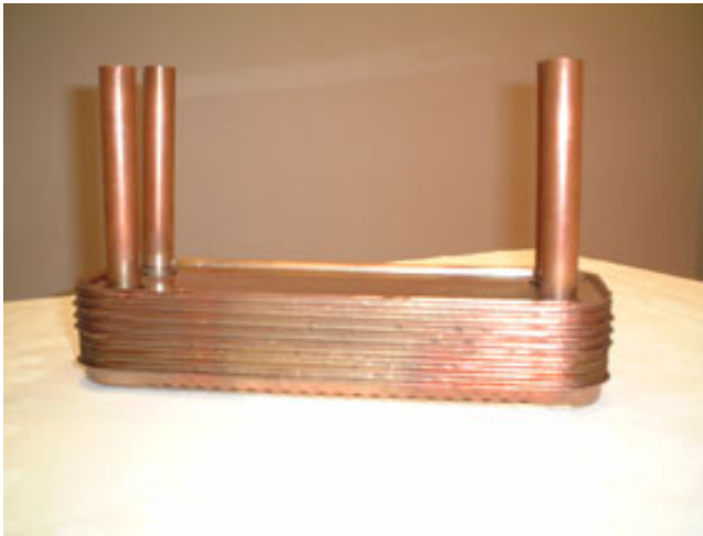
銅めっきステンレス鋼と銅材を用いた 複合熱交換プレートの試作例 (上下それぞれ2枚ずつがステンレスプレート)
