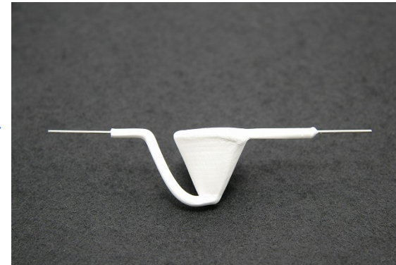
タングステンバスケットヒータ(蒸発前)
