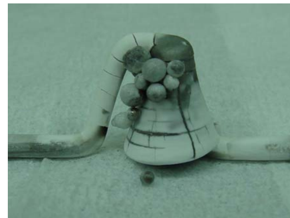
亀裂、熔融金属漏れ出す(蒸発後)
