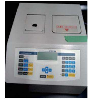
図3：発光量を測定するルミノメータ
