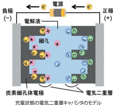
近年では、ハイブリッド型電気自動車の補助電源や夜間電力貯蔵庫としても電気化学キャパシタは期待されており、エコ社会実現のためのキーデバイスの一つです。電気二重層キャパシタの欠点は、競合デバイスである二次電池と比較した場合の蓄積エネルギーの低さです。これを克服するためには、より大きな容
