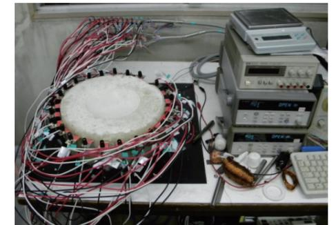
計測システムの外観と 人体の腹部を模したファントムでの実験
