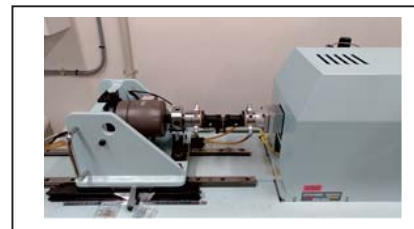
図3 微小変位制御万能試験機
