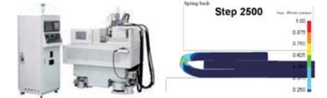
図3 超精密非球面加工機 図4 薄板の折り曲げ成形加工解析例
