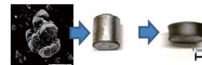
図5 鉄系粉末の成形と冷間鍛造
