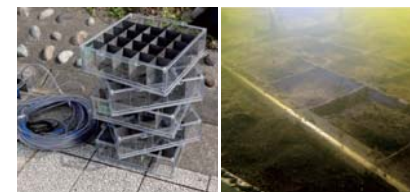
実底質汚染環境への適用試験 (左: 装置外観、右: 実際に埋め込んだところ)
