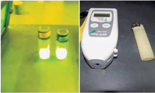
写真2 センサーキット（左は試薬、右は測定装置）
