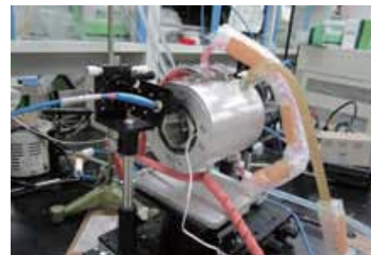
超臨界二酸化炭素/水界面における化学反応を直接分光測定するための装置
