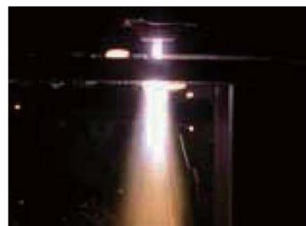
金属切断に用いる高温高速流のプラズマアーク
