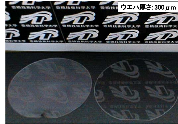
EPD研削前 EPD研削後 図 EPD研削前後の水晶ウエハの概観
