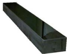
ELID研削+超精密研磨+EEMの連携加工プロセスより試作した長尺XFELミラーの外観及び形状精度 (理研・大阪大と共同研究)
