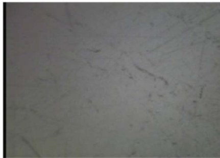
ICF膜の被覆有り 摩擦後
